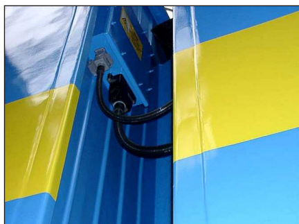
foto. 5. Połączenie międzywagonowe w EN57 - po modernizacji. Widoczne rury PMA.
